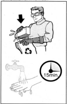
SOLLTE DER AKKU UNDICHT WERDEN ENTFERNEN SIE ES UNTER VERMEIDUNG JEGLICHEN HAUT- UND AUGENKONTAKTES MIT DER AUSTRETENDEN FLÜSSIGKEIT AUS DEM FAHRZEUG UND PACKEN SIE ES IN EINEN PLASTIKBEUTEL. WIE SIE DEN AKKU ENTSOR-GEN KONNEN ENTNEHMEN SIE BITTE DER BEDIENUNGSANLEITUNG.
