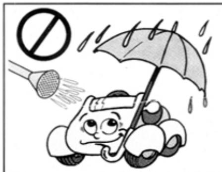
**FAHRZEUG, STECKVERBINDUNGEN, MOTOREN BZW. AKKUS VOR NASSE SCHÜTZEN. FAHRZEUG NIEMALS MIT EINEM SCHLAUCH ABSPRITZEN.**
