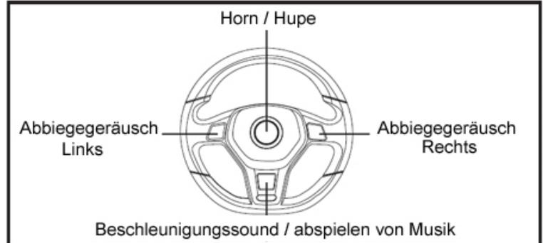
**Links abbiegen:** Wird die linke Lenkradtaste betätigt ertönt ein klickendes Blinkergeräusch und der linke vordere Blinker beginnt zu blinken.
