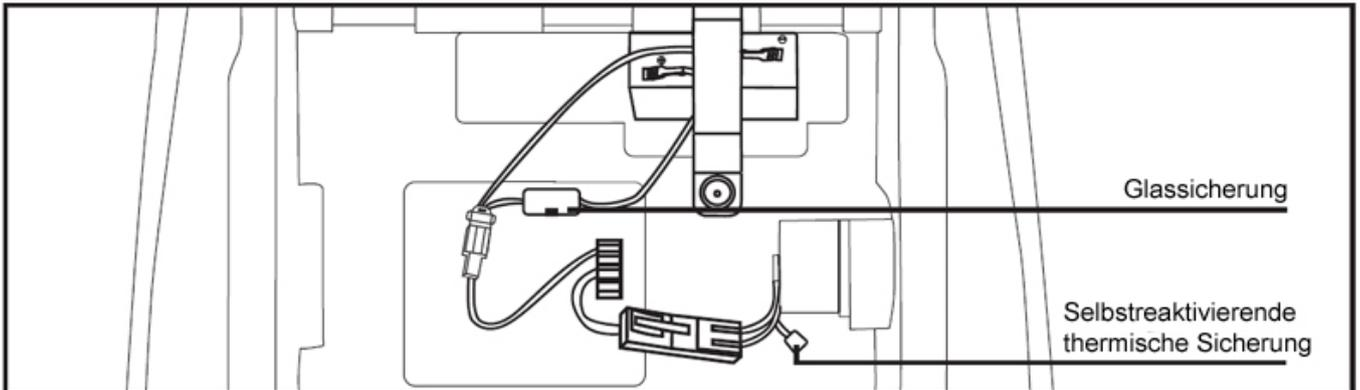
1. Unter dem Sitz befindet sich eine Glassicherung für den Überspannungsschutz.
