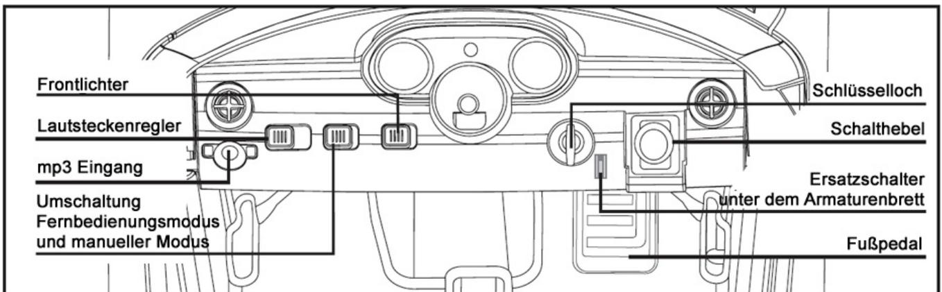
Stecken Sie den Schlüssel ins Schlüsselloch und drehen Sie es nach rechts bis ein Klickgeräusch zu hören ist.
