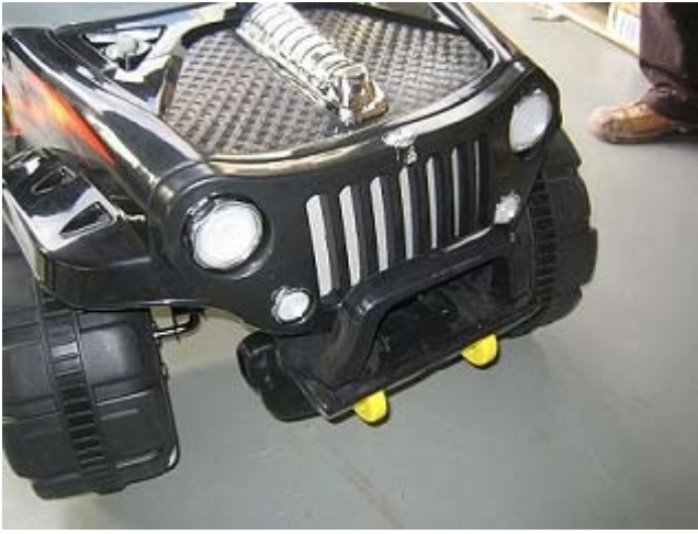
19. Positionnez le pare-chocs avant et fixez-le sur le châssis à l'aide des vis livrées.
